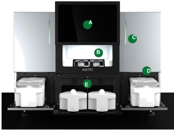
Hình 5. Màn hình cảm ứng trung tâm (A) giúp đơn giản hóa các thao tác. Các ngăn chứa hai flow cell (B), một ngăn cho mỗi bên, và màn hình LED (C) thông báo trạng thái của một bên. Hóa chất (D) và chai thải (E) được nạp và lấy ra khỏi thiết bị một cách trơn tru.
